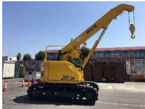
小型クレーン
