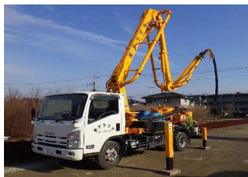
コンクリートポンプ車
