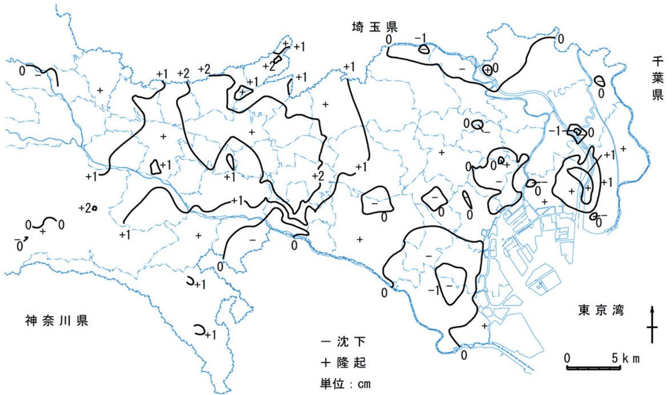
図-3 最近5年間の地盤変動量図（平成28年～令和2年）
