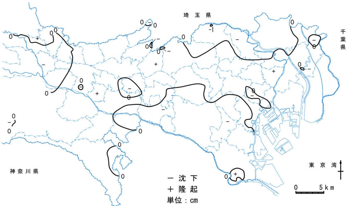
図-2 令和2年の地盤変動量図
