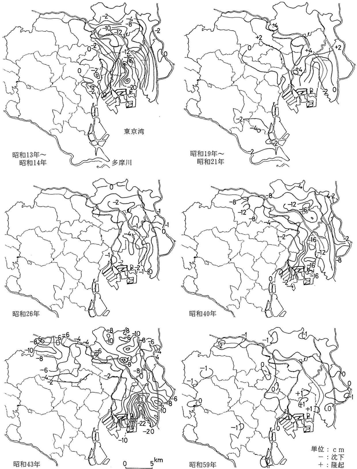
図-15 区部の地盤変動状況の変遷
