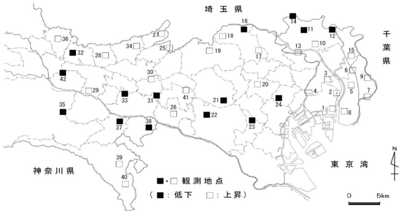
図-5 令和2年の地下水位変動状況図
