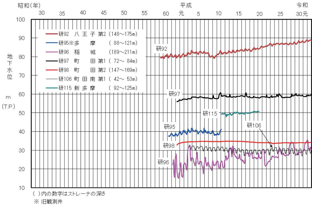
図-12 主な観測井の地下水水位変動図（八王子市、多摩市、稲城市、町田市）
