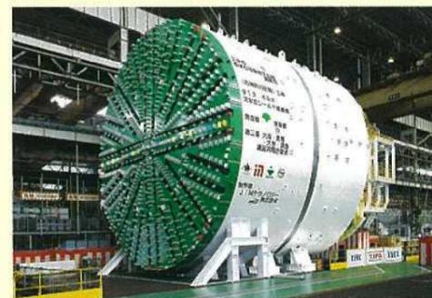
トンネルを掘削するシールドマシン(外径 13.45m)
