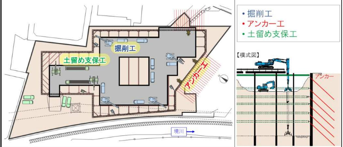
ステップ4・5では、掘削と土留め支保工、基面整正工を行います。
