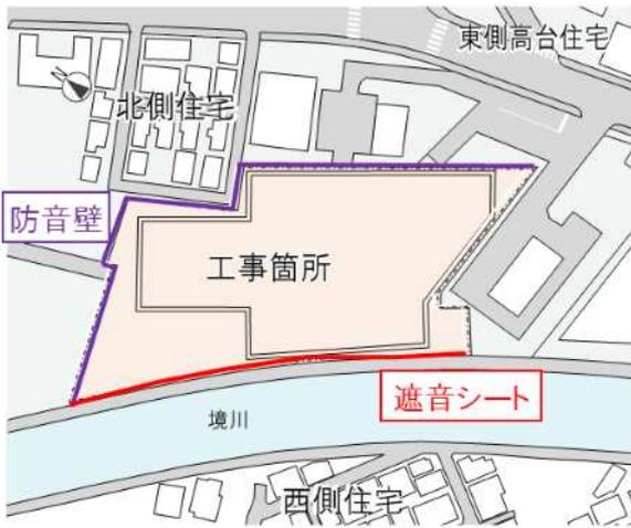
・住宅が隣接する場所には防音壁を設置し、既存仮囲いには遮音シートを設置することで、騒音を抑制いたします
