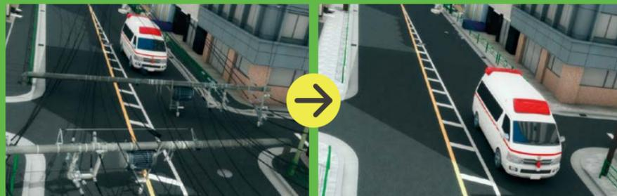
災害時に電柱が倒れて救急車や消防車の通行を妨げることがなくなります。また、電気や電話などのライフラインも壊れにくくなります。
