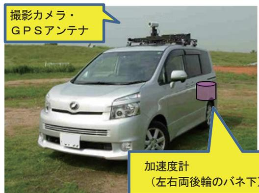
写真-2 路面段差測定車
