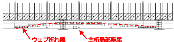
図-2 主桁当て板補強
