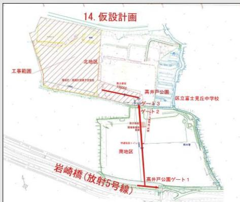
工事の着手前準備として通行用鉄板、現場事務所と仮設トイレの設置を行います。
