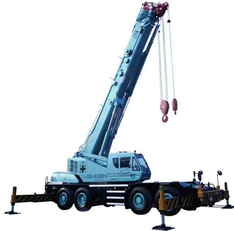
ラフタークレーン(吊り荷重13t~80t級)
