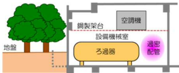
＜交換可能な配管部材のみ更新した例＞
