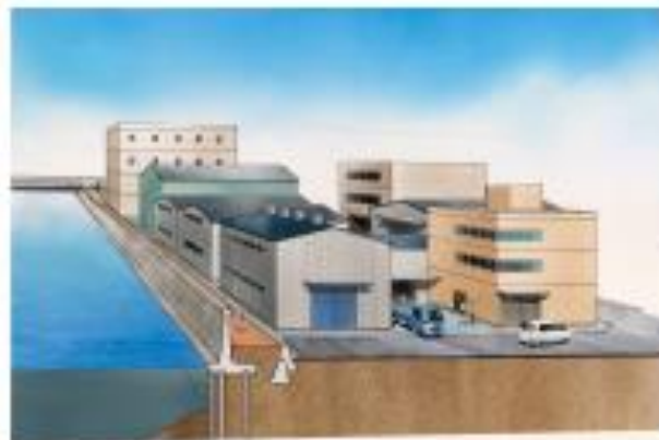
現況の高潮防潮堤
