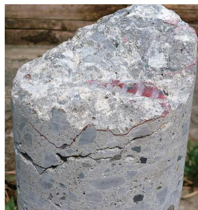
写真-11 鉄筋下面の再注入樹脂
