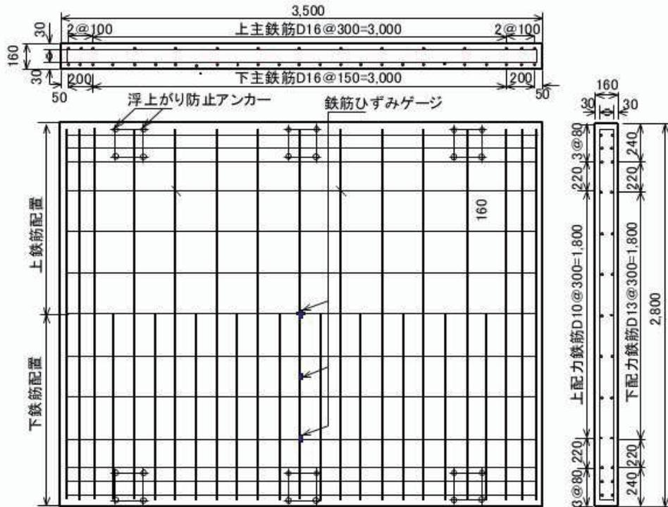
図-1 試験体の形状寸法
