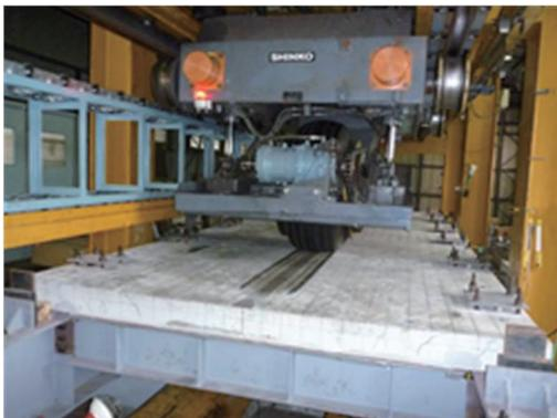
写真-1 輪荷重走行装置
