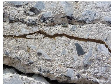
写真-9(b) 再注入時の樹脂 (PL-1⑤-B断面)
