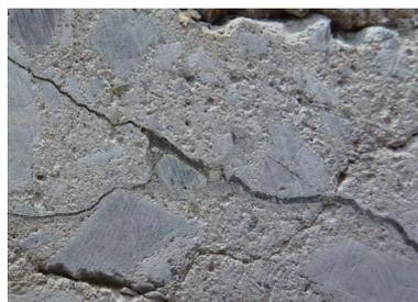
写真-9(a) 接着時の樹脂 (PL-1①-A断面)
