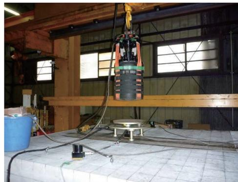
写真-12 重錘落下たわみ測定状況
