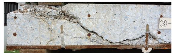
写真-8(b) 鋼板端部アンカーの押し抜きせん断破壊の状態
