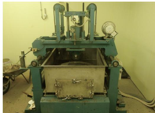
写真-4 ねじり骨材飛散試験
