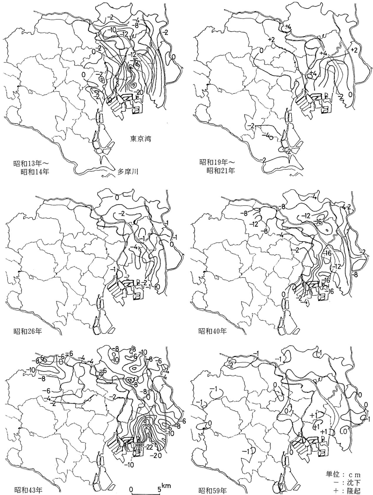
図-15 区部の地盤変動状況の変遷
