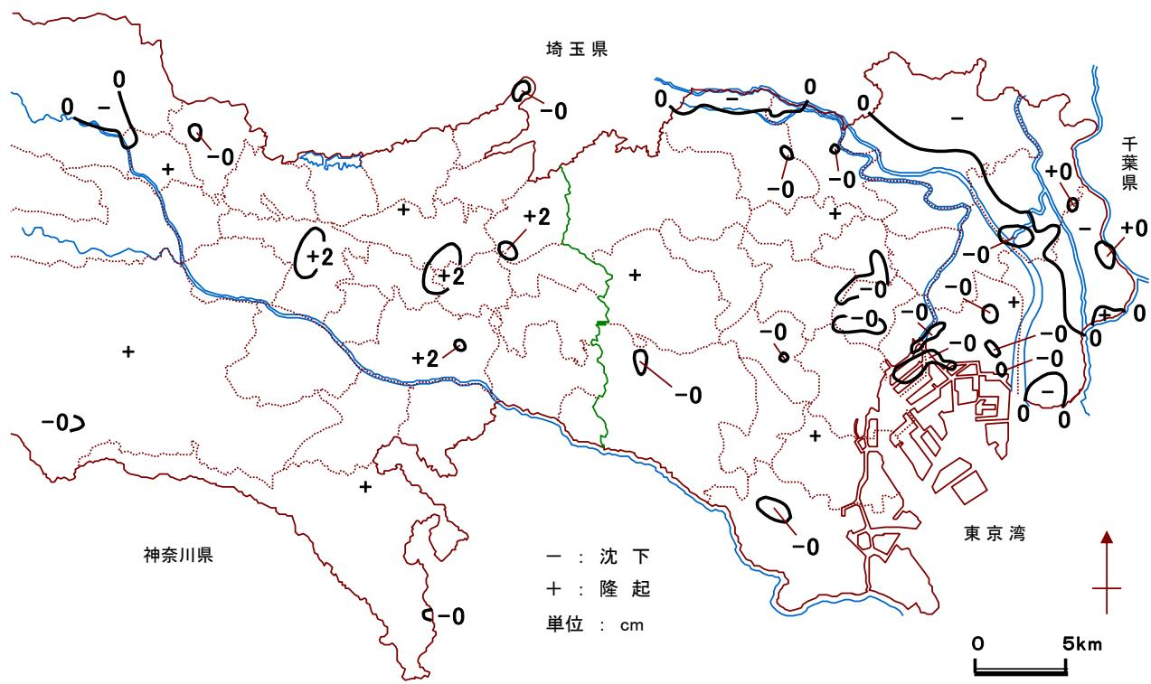
図-3 最近5年間の地盤変動量図（平成24年～平成28年）
