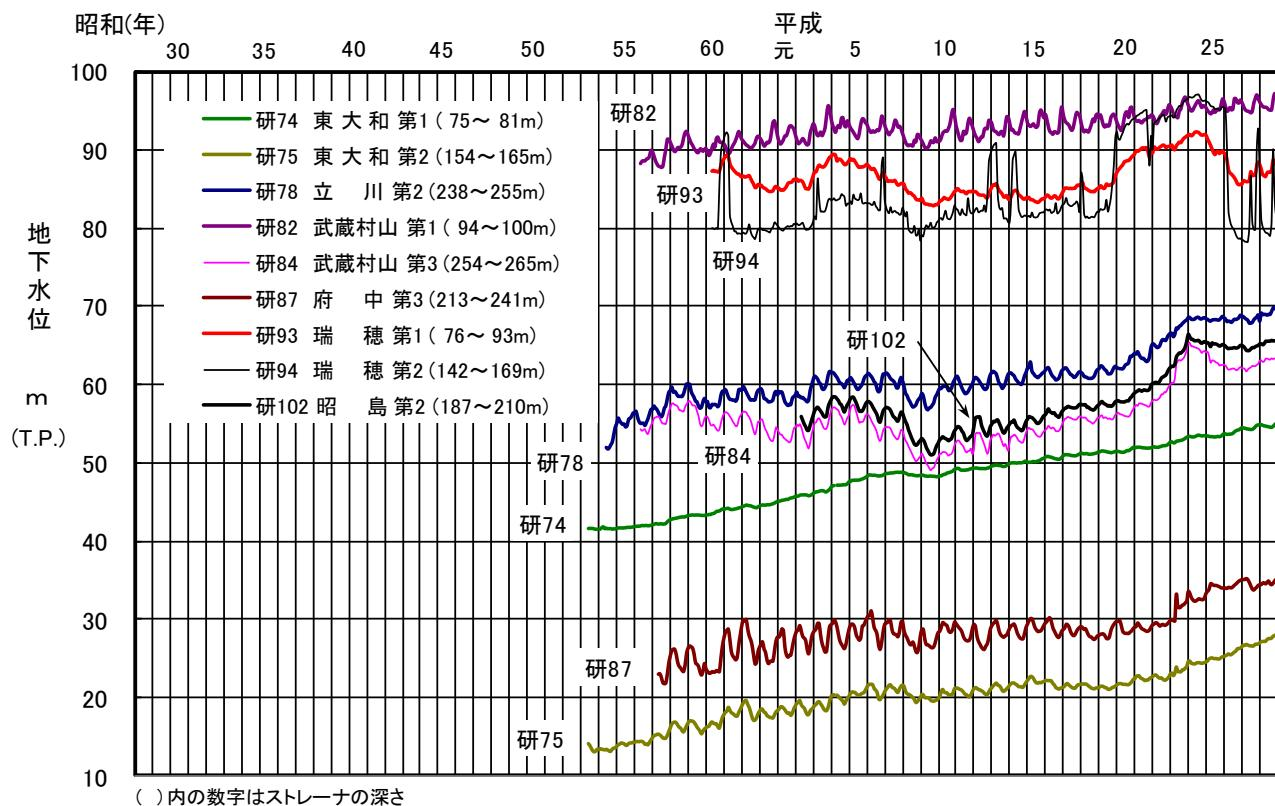
図-11 主な観測井の地下水位変動図（東大和市、武藏村山市、瑞穂町、昭島市、立川市、府中市）
