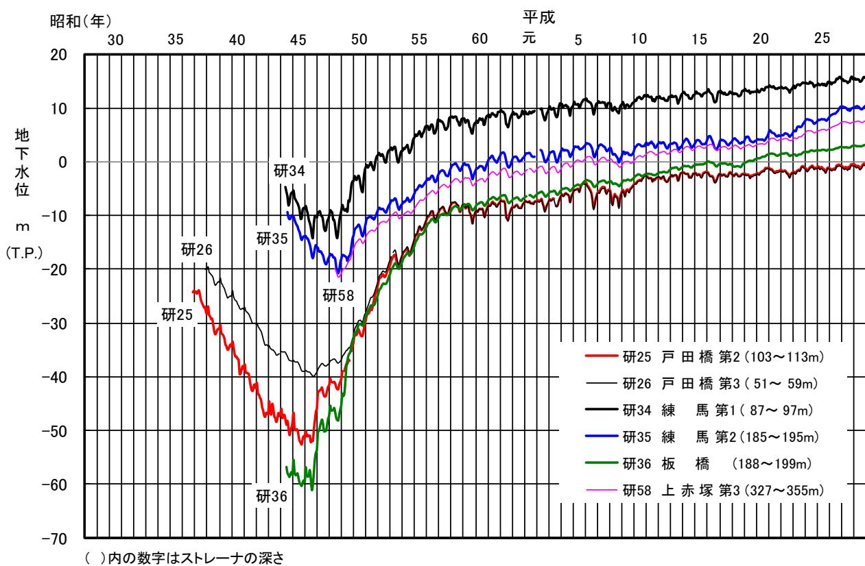
図-8 主な観測井の地下水位変動図（板橋区、練馬区）
