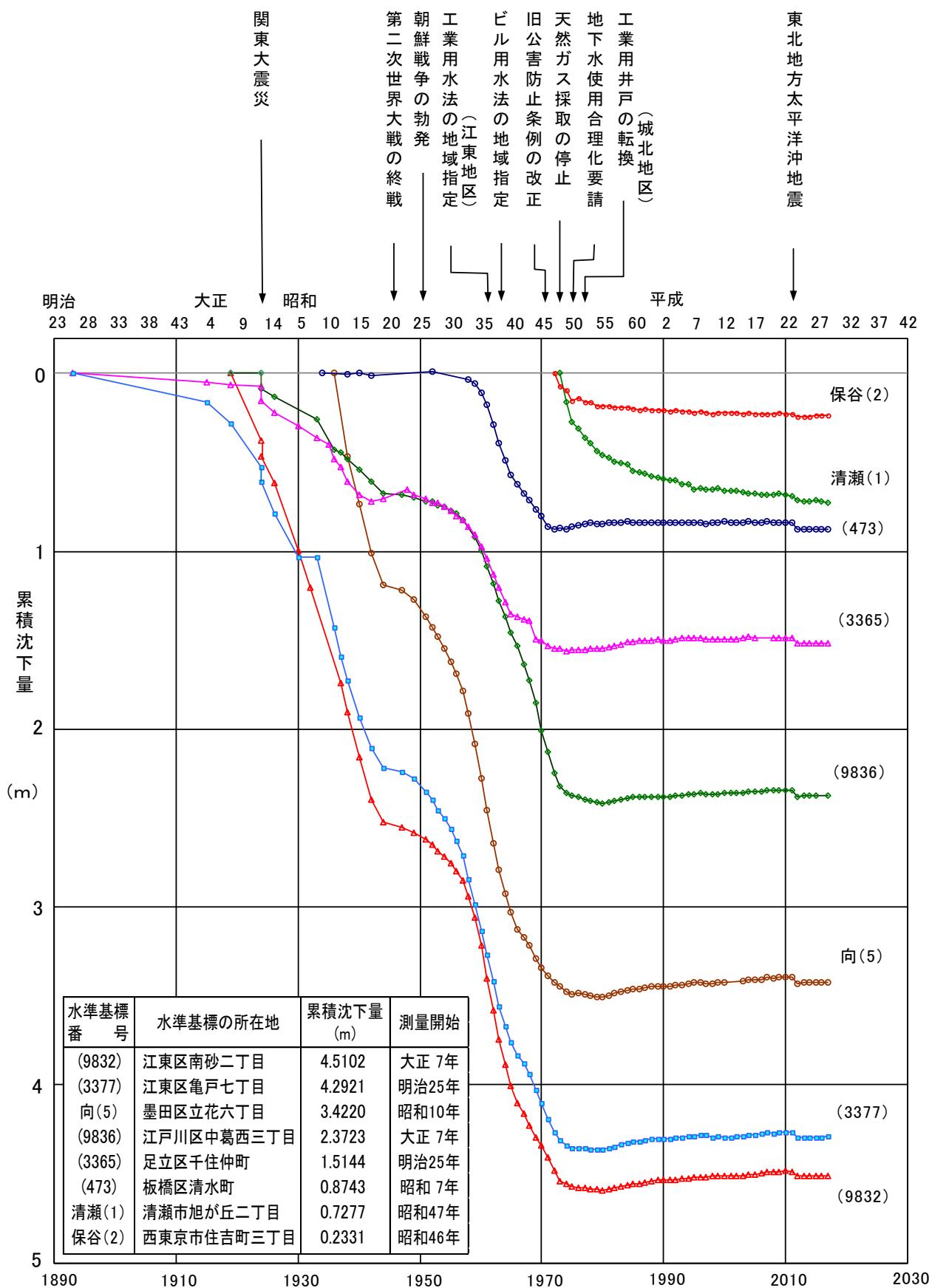
図-14 主要水準基標の累積沈下量図
