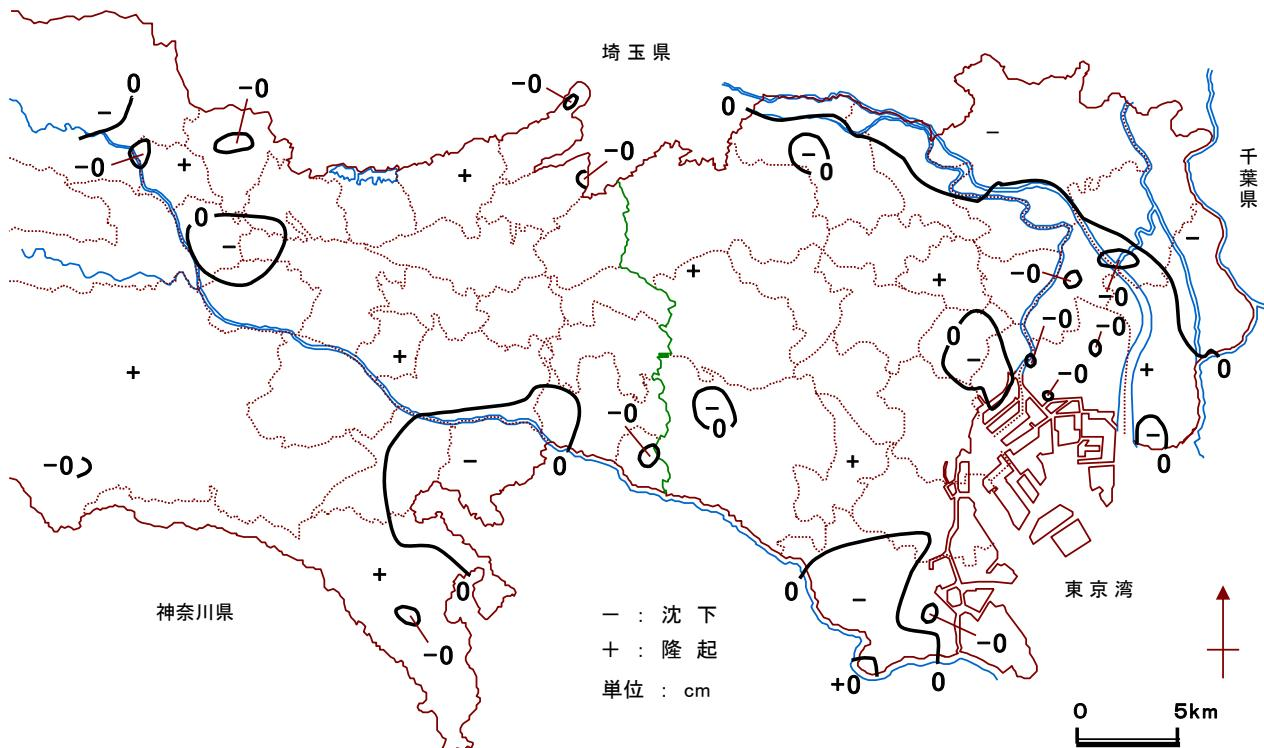
図-2 平成28年の地盤変動量図
