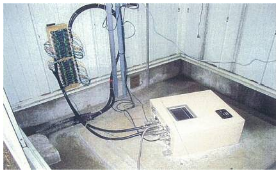
写真-2 強震計外觀 (地表面)
