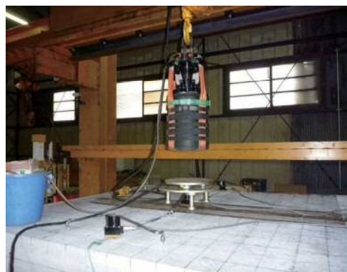
写真-9 重錘落下たわみ測定状況
