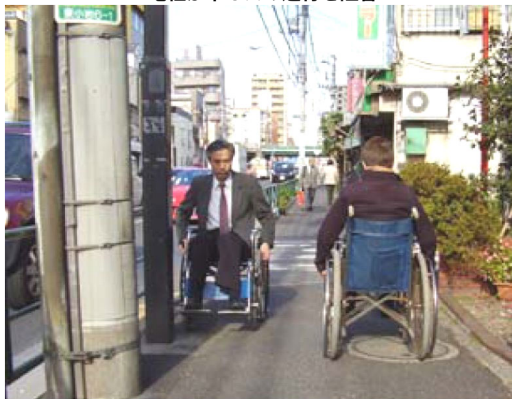
電柱が車イスの通行を阻害
