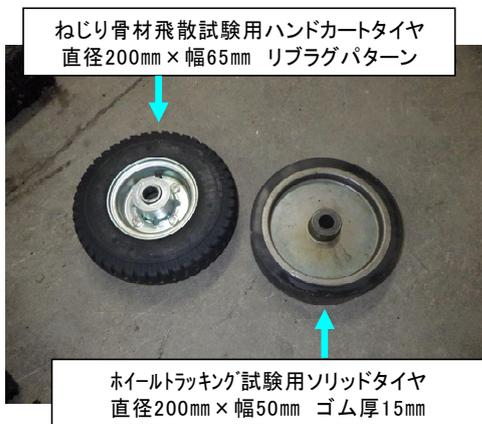
写真-13 試験用タイヤ (ハンドカートタイヤ)
