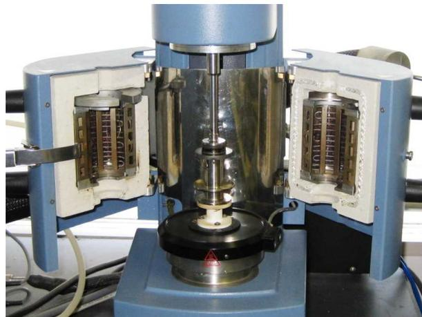
写真-10 DSR 試験 動的粘弾性測定装置の外観
