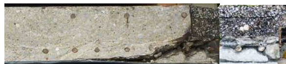
(a) SM8+C 床版 B1 (6.9 万回で破壊)
