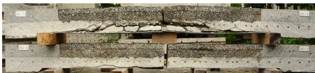
(a) SM8+C (6.9 万回で破壊)
