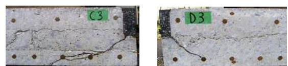
(c) SM12 床版 C3-D3 切断面 (10.4 万回まで未破壊)
