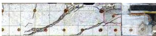
(c) NT8+C 床版 D3 (42.6 万回で破壊)
