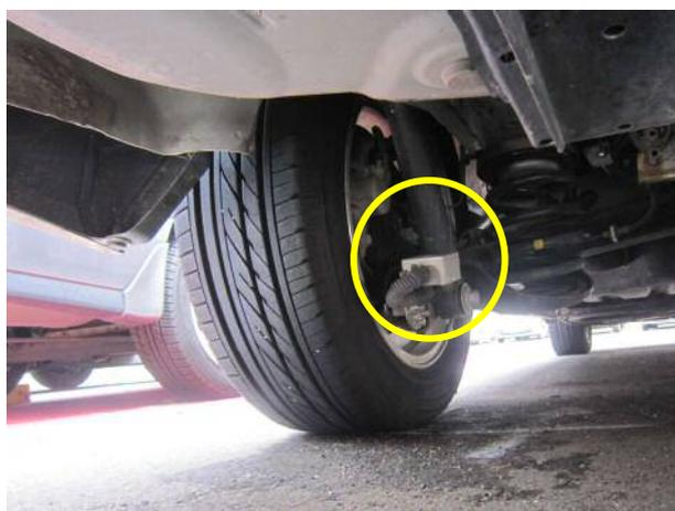
写真-1 加速度計の設置位置
