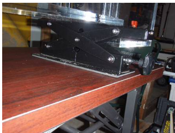
写真-2 水路下のジャッキ
