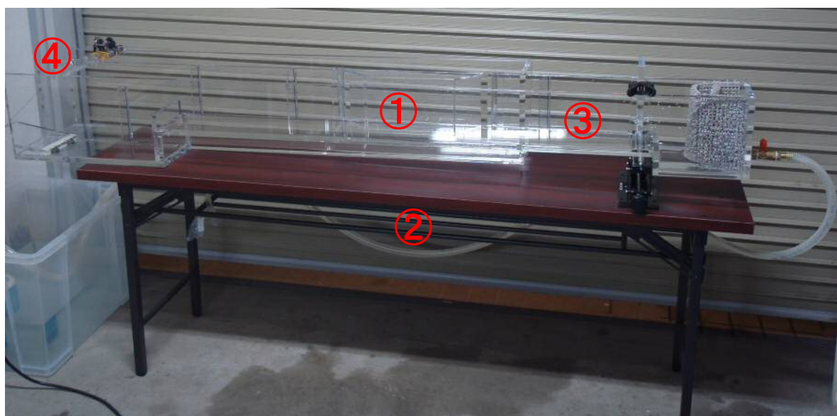
写真-1 河川水理模型全景
