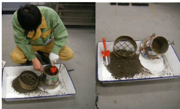
写真-1 ハンドスコップ掘削試験状況
