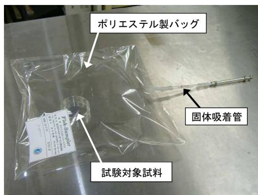
写真-2 定性分析用バッグ及びガス採取状況
