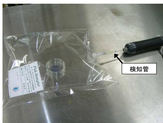
写真-3 検知管によるガス採取状況
