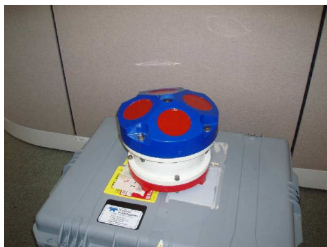
図-7 船の下に設置してある ADCP センサー
