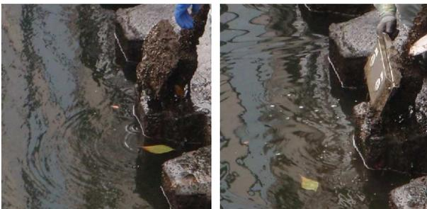
写真 - 1 流速計周辺の付着物
