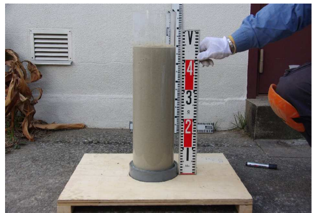
写真 - 1 アクリル管への処理土打設状況
