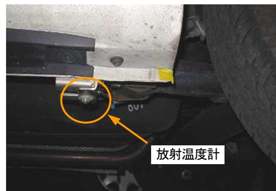
写真-2 放射温度計(車体下)
