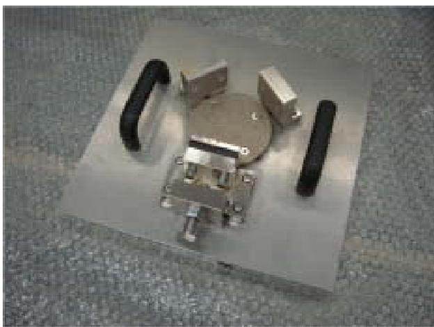
写真 - 11 供試体固定用治具
