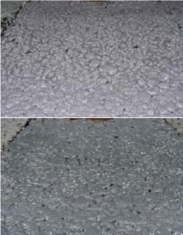
写真 - 12 100万輪走行後の供試体表面状況
