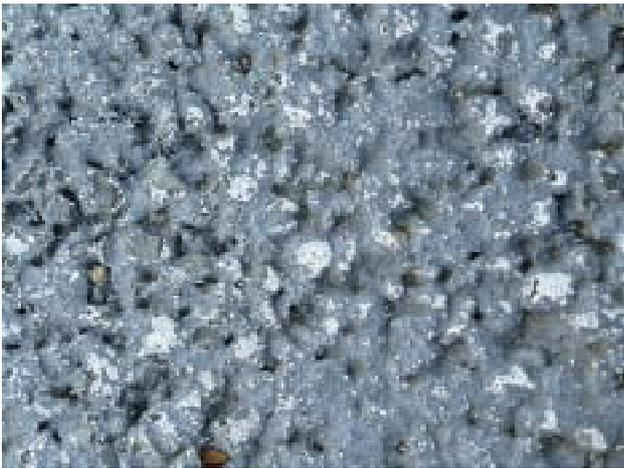
写真 - 3 遮熱材の摩耗
