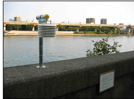
写真 - 2 隅田川堤防温度計測状況(2007年・言問橋)
