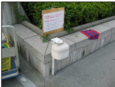
写真 - 5 堤外テラス温度計測状況(2006 龍神大橋)
