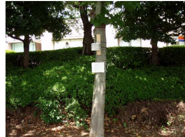
写真 - 17 高木下温度測定状況(2008 明石町河岸公園)
