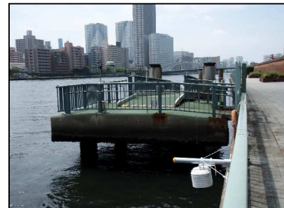
写真 - 4 隅田川水面上外気温計測状況(2008 佃大橋)
