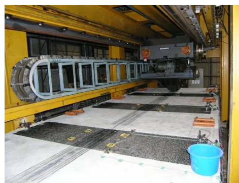
写真-1 輪荷重走行試験状況
