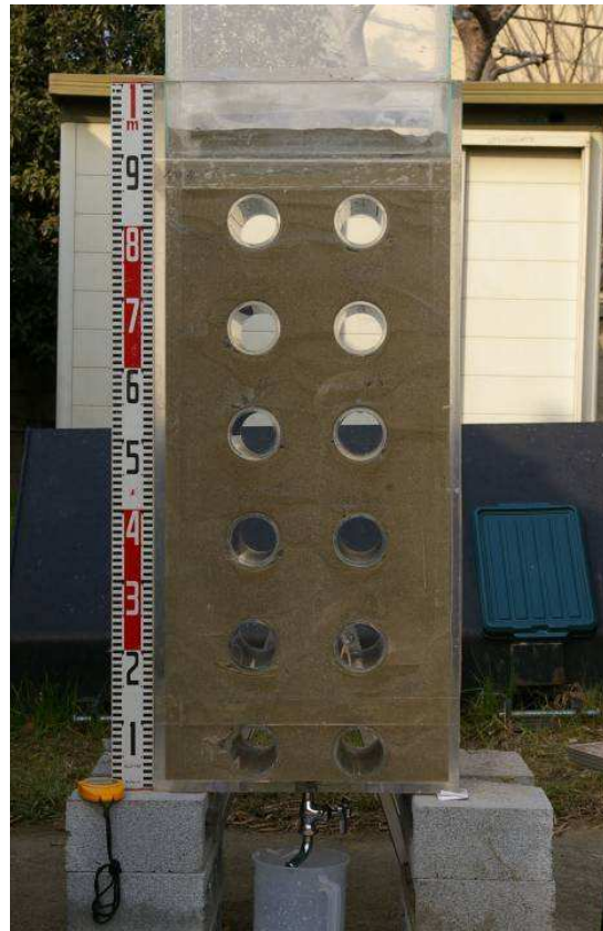
写真 - 2 輻輳管の水締め実験状況
