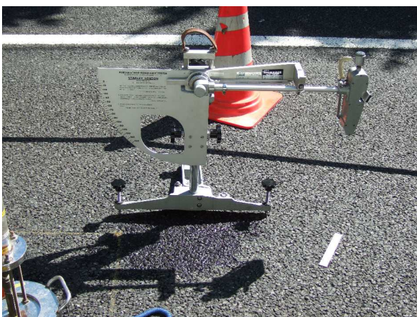
写真 - 3 舗装路面に対する振り子式スキッドレジスタンステスト試験
