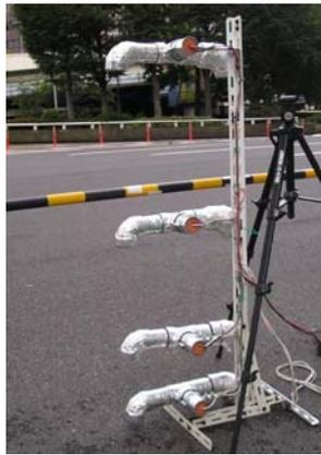
写真-7 強制通風式気温
