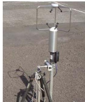
写真-3 超音波風速温度計
