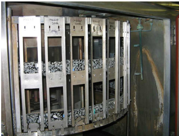
写真-1 促進耐候性試験機への供試体の設置状況
