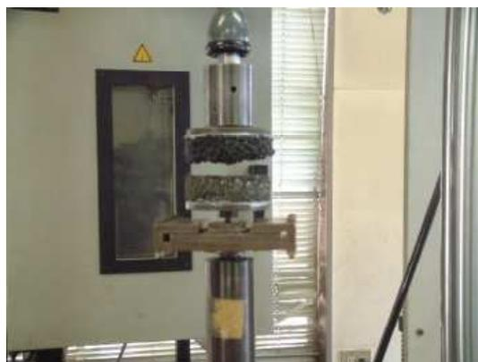
写真-5 円筒供試体の引張試験状況
