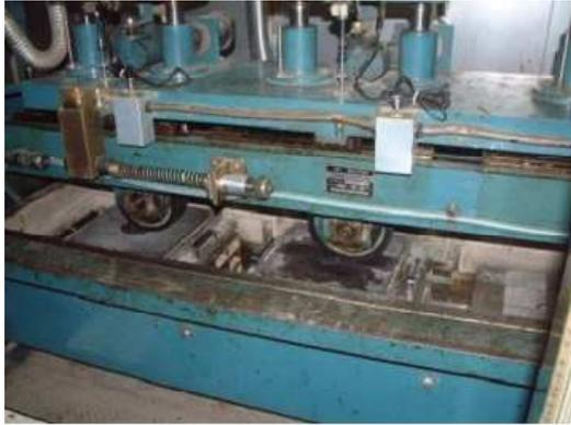
写真-7 簡易ポットホール走行試験状況
