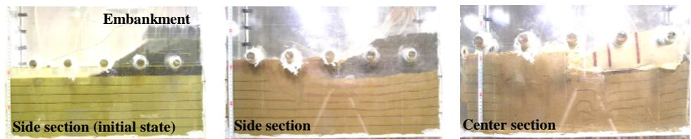
写真 - 1 実験後の地盤破壊状況
