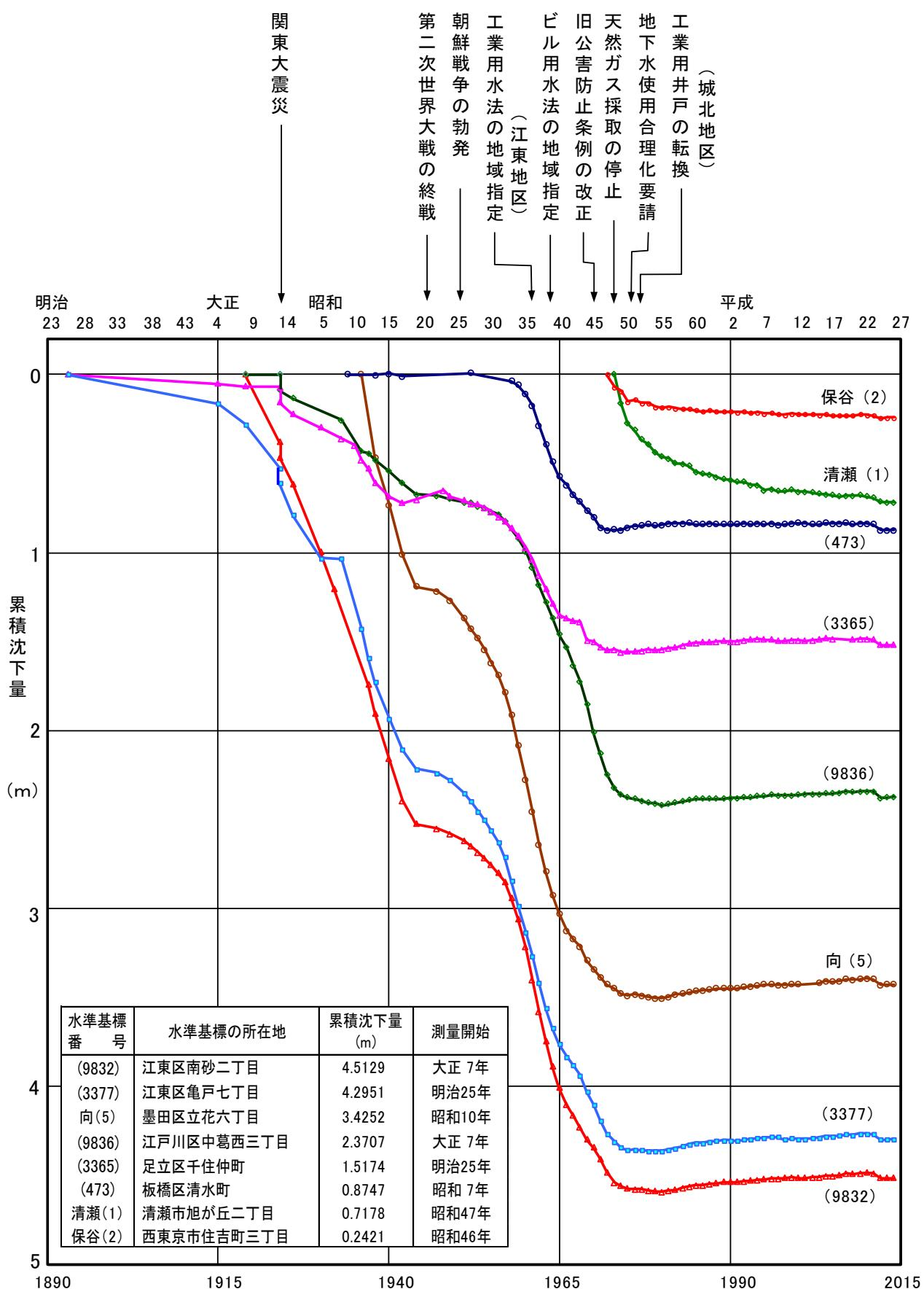
図-13 主要水準基標の累積沈下量図
