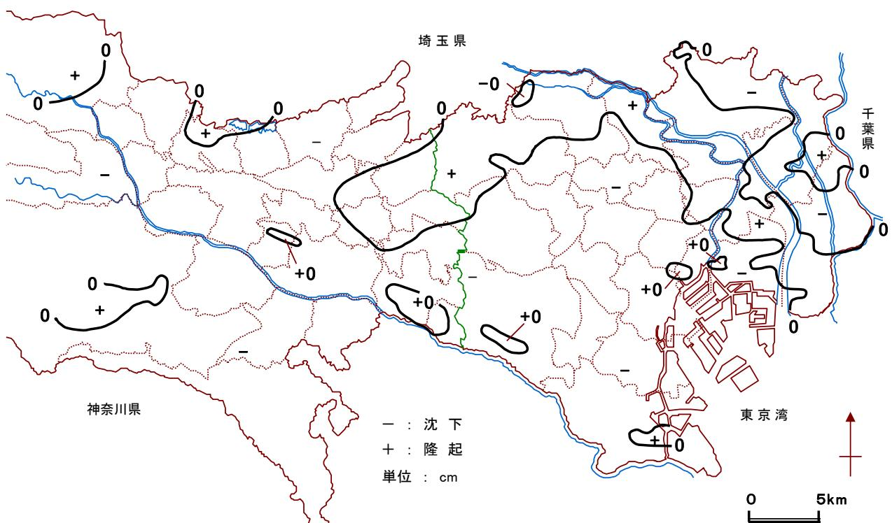
図-2 平成25年の地盤変動量図
