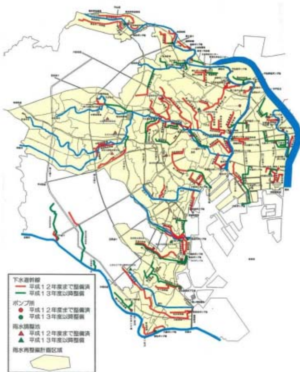
下水道雨水排水整備状況図
