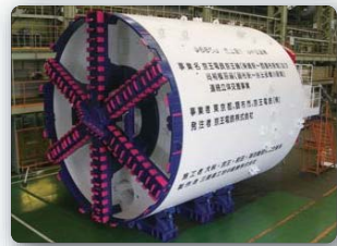
国領立坑～調布東立坑間を掘削するシールドマシン
