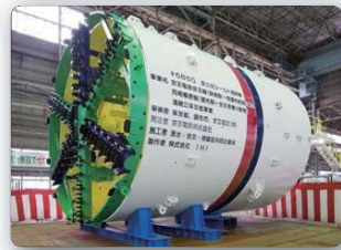
調布西立坑～鶴川立坑・品川立坑間を掘削するシールドマシン
